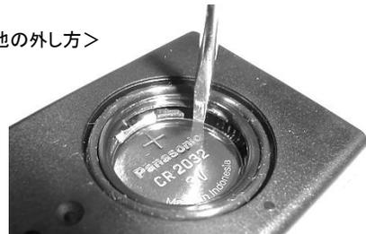
上図で示した位置にマイナスの精密ドライバーなどを浅くかけて、電池を手前に引き出します。
